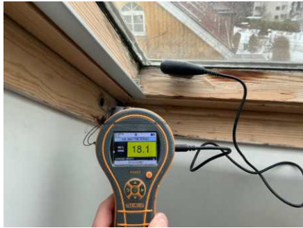
Fuktnivå over normale verdier i vinduskarm på loft.
