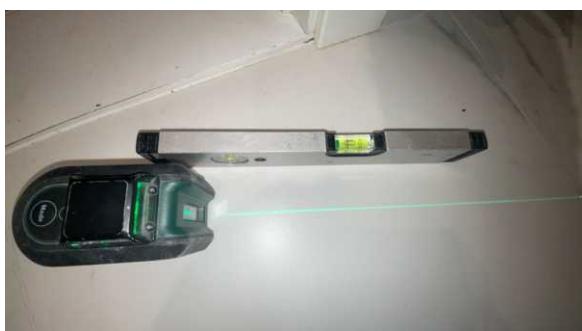
Fallforhold målt i retning sluk.
