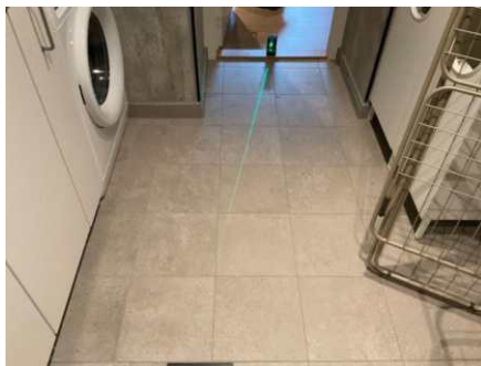
måling av fall m/laser.
