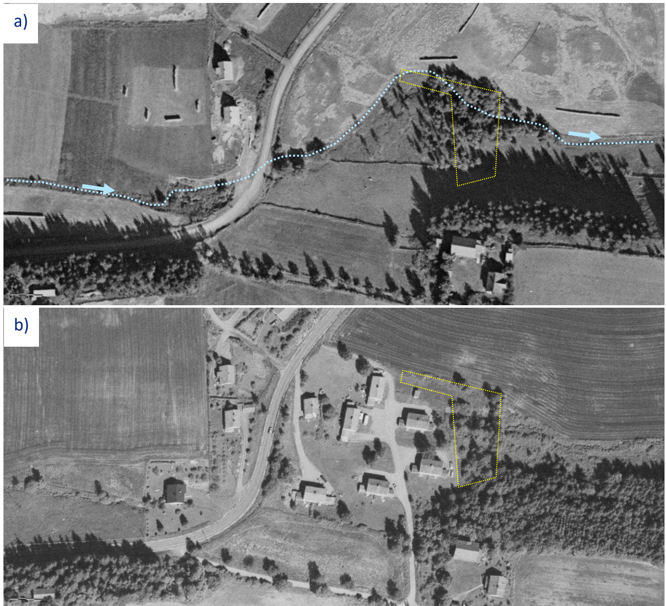
Figur 9 Flyfoto over kartleggingsområdet (omtrentlig markert med gul boks) hentet fra a) 1953 b) 1989. Flyfoto over tidsrommet viser at areal rundt kartleggingsområdet har endret seg mest rundt 1960 tallet, med utbygging av det meste av dagens bebyggelse. Bekken er vurdert til å ha blitt lagt i rør mellom 1957 og 1963, men det er noe usikkert da flybildene er vanskelig å tyde. Bekkens originale dreneringsløp vurdert fra flybildene fra 1953 er markert i stiptet blå linje. Kilde Norge i Bilder (Statens vegvesen, Kartverket, 2026 og NIBIO, 2026).
