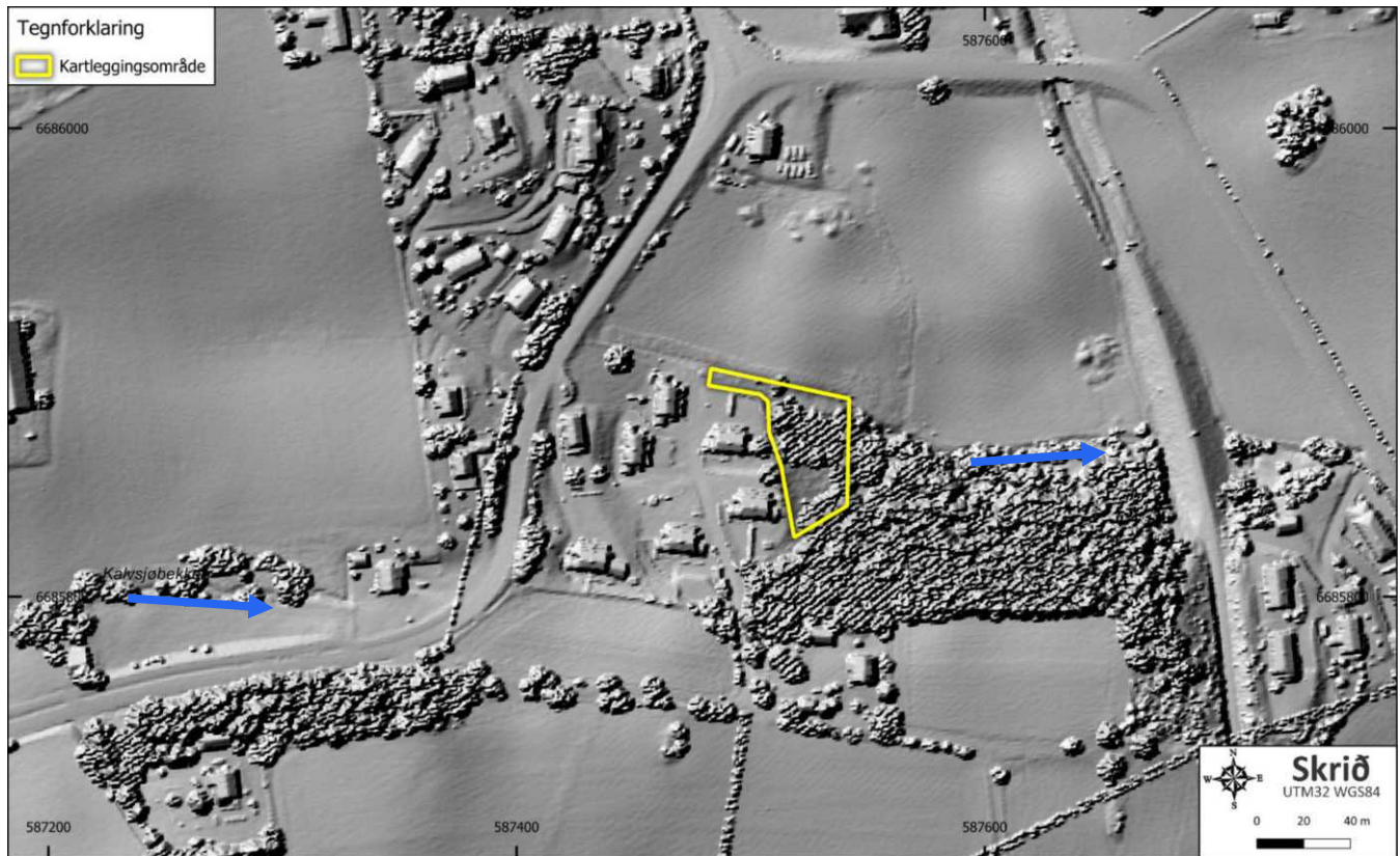
Figur 7 Skyggedata 2D illustrasjon ved bruk av overflatemodell fra LiDAR data (DOM). Av DOM dataene fremheves bygninger og vegetasjon på en god måte. LiDAR datagrunnlag er 1x1 meter. Blå pil viser bekkens strømningsretning. Kilde Kartverket, 2026b
